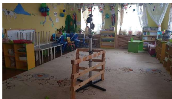
Зураг 5. Өрөөний агаарын температурын тархалтын хэмжилтийн төхөөрөмж суурилуулсан байдал
