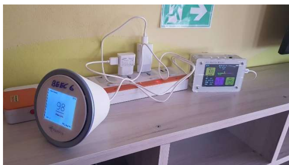
Зураг 4. Дотор агаарын чанарын хэмжүүрүүд ангид суурилуулсан байдал
